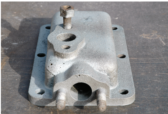
Fig. 9. Coperchio del cassetto di distribuzione dopo la sabbatura.
