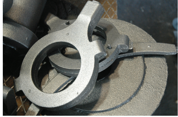
Fig. 8. Componenti realizzati mediante fusione.
