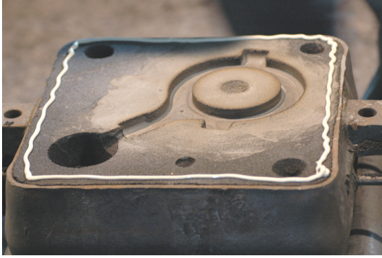
Fig. 7. Realizzazione del piede di biella: staffa con calco in terra per la fusione in ghisa.
